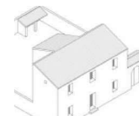
Tre cellule sul fronte strada raddoppiate in profondità su due livelli
